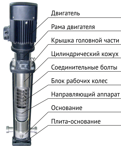
Рис.2. Конструкция насосов
